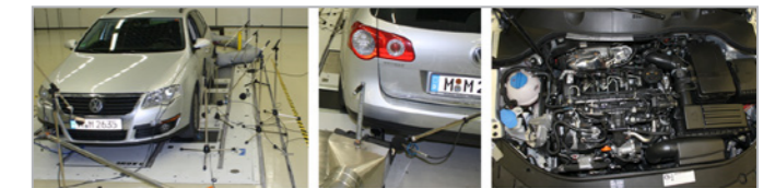
Abb. 6: Messaufbau für die Beitragsanalyse bei der Messung der simulierten Vorbeifahrt mit Mikrofonen am Ansaugtrakt, an den Reifen, am Auspuff und im Innern des Motors. Beschleunigungssensoren am Motor und der Abgasanlage liefern zusätzliche, wertvolle Informationen zu Statistikzwecken.
