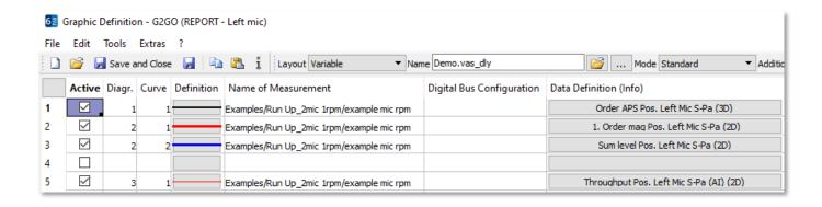
Dans l'exemple ici, on affichera pour une même voie des analyses calculées à la mesure : un « Order APS », un « Order mag », un « Sum level », ainsi que le signal temporel « Throughput » de la voie concernée.
